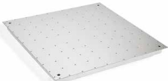
Mukavemeti yüksek hafifletilmiş özel beton karışımı ile paslanmaz çelik sactan elde edilen üst ve galvaniz sactan elde edilen alt panellerin, kaynak ve kimyasal kullanılmadan birleştirilmesi ile üretilmiştir.
