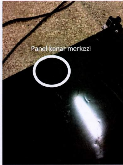
Fotoğraf 7: Panel kenar merkezinde dinamik yükleme deneyi ve deney sonrası görünüm
