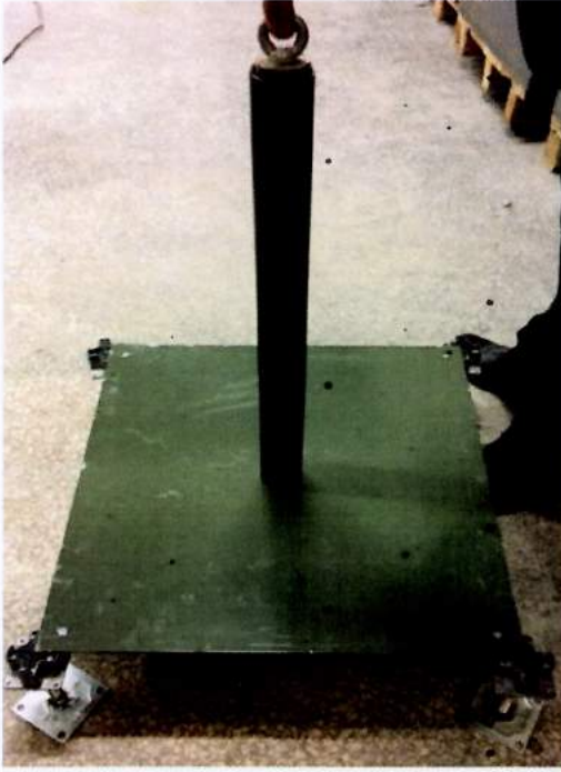
Fotoğraf 6: Panel merkezinde dinamik yükleme deneyi ve deney sonrası görünüm
