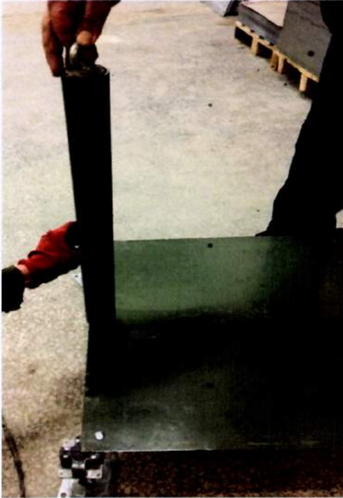
Fotoğraf 7: Panel kenar merkezinde dinamik yükleme deneyi ve deney sonrası görünüm
